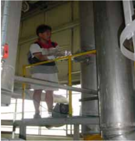
그림3-21 헥사민 제조시설 배출구 시료채취 모습
